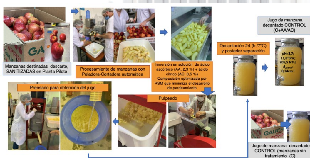
Figura 3.2.9. Secuencia de la utilización de manzanas descarte para la obtención de jugos estabilizados
