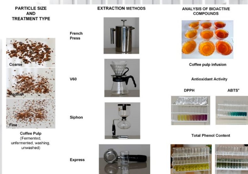
Figura 3.2.18. Esquemas de las etapas de obtención y análisis de las infusiones de pulpa de café
